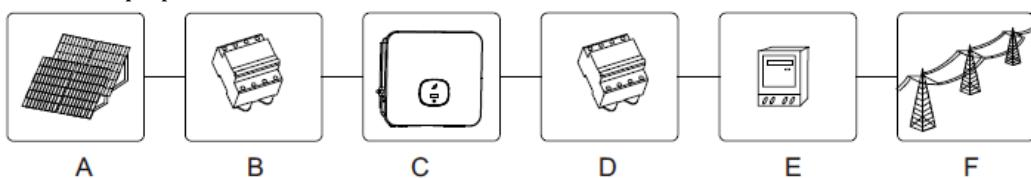
A – Соларен панел; B – DC прекъсвач; C – Инвертор; D – AC прекъсвач; E – Електромер; F – Електропреносна мрежа
